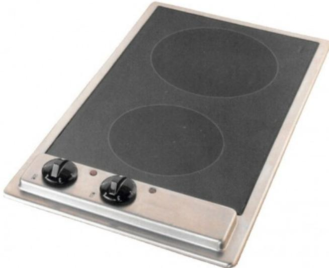
1 zone radiante 145 mm / 1200W . 1 zone radiante 185 mm / 1700W . Témoin lumineux de mise en marche . Voyants de chaleur résiduelle . Tension 230V / 50 Hz . Dimensions : L 51 x 28,8 cm . Encastrement : L 49,4 x l 27 cm
