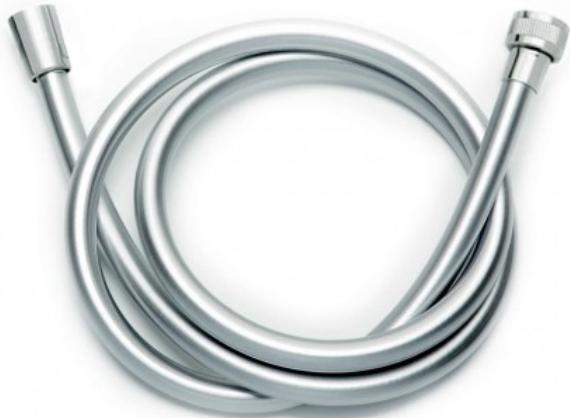
Flexible en PVC renforcé avec 18 fils de polyester. Fabriqué sous les normes EN1113 européenne. Tube intérieur en PVC alimentaire (5 couches). Résistance à traction: 30 Kg. Écrou 0 moleté 1/2" | Écrou 1 conique 1/2" COLORIS: Gris argent.
