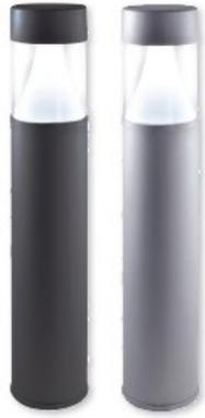
Borne LED 18W en matériaux composites équipée d'un réflecteur de diffusion lumineuse haute performance et d'une optique cylindrique en polycarbonate transparente. Anti-éblouissement par rétro-éclairage, cette borne se caractérise par sa tenue dans le temps; elle est inaltérable, résistante à toute corrosion, à tout type d'oxydation, aux agents extérieurs ainsi qu'aux UV. Luminaire équipé d'un détecteur de mouvement HF paramétrable
