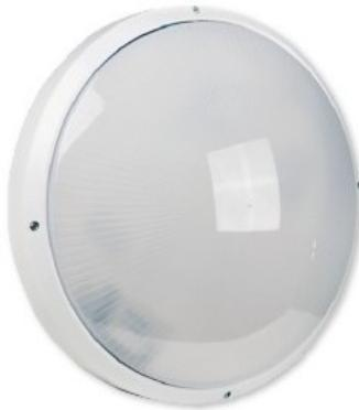
Hublot équipé de deux douilles E27Lampes halogènes jusqu'à 2x46WLampes fluocompactes jusqu'à 2x25WLampes LED jusqu'à 2x15WCorps en nylon renforcé de fibres de verre avec jupe anti-arrachementDiffuseur opale prismatique, anti choc et auto-extinguibleVisserie anti-vandale TORX avec embout spécifiqueBornier poussoir à insertion directe, double ligne de pontage (section 1.5/2.5mm<sup>2</sup>)
