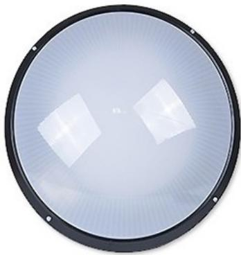
Hublot équipé de deux douilles E27 Lampes halogènes jusqu'à 2x46W Lampes fluocompactes jusqu'à 2x25W Corps en nylon renforcé de fibres de verre avec jupe anti-arrachement Diffuseur opale prismatique, anti choc et auto-extinguible Visserie anti-vandale TORX avec embout spécifique Bornier poussoir à insertion directe, double ligne de pontage (section 1.5/2.5mm<sup>2</sup>) Alimentation directe 220/240Vac
