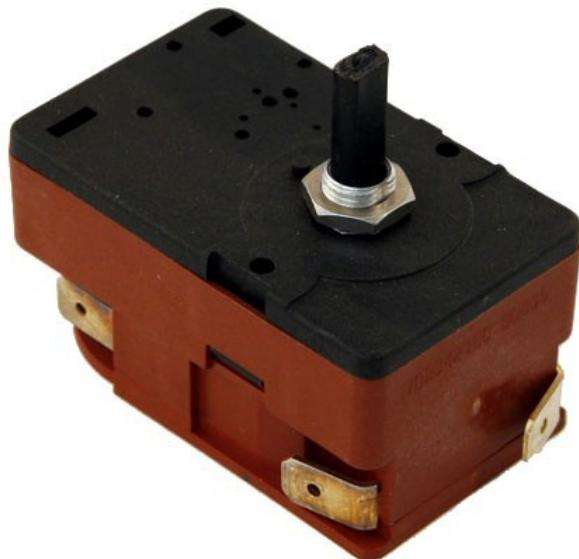
MINUTERIE 60 MINUTES BIPOLAIRE 2NO LAT L23N + DOUILLE Conforme à la norme EN 60730-2-1 Contacts en argent Fixation par écrou central ou bien par deux vis. Longueur de l'axe 12 mm Dimensions largeur 34.5 \* longueur 56 \* épaisseur 29
