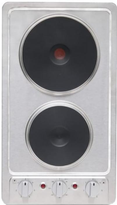
Table de cuisson encastrable finition inox. Equipée d'une minuterie. Puissance totale 3000 watts composée de deux foyers fonte, à l'avant 1500 watts diamètre 145mm et à l'arrière 1500 watts 180mm. Commande par manettes. Livrée avec cordon (sans prise), pattes de fixation et joint. Dimensions du produit (H\*L\*P) L 290 x P 510 x H 42,5mm. Encastrement L 270 x P 490mm. Poids 4,25 Kgs.
