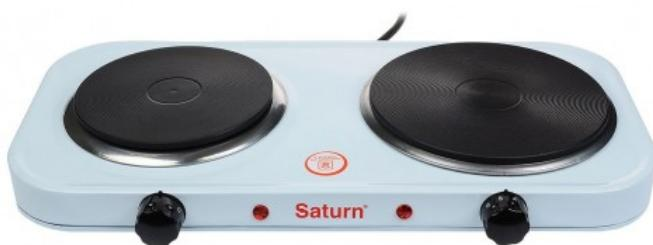
Le réchaud électrique SATURN EC181 permet de réaliser un grand nombre de préparation culinaires grâce à ses foyer de cuisson en fonte de 145 et 180 mm de diamètre d'une puissance de 1000 watts (petit) et 1250 watts (grand). Equipé de deux thermostats, sa température de fonctionnement est réglable. Pour la sécurité, il est équipé de deux voyant lumineux et d'une sécurité de surchauffe. Stable, il repose sur quatre patins anti-dérapants. Avec cordon 1m.
