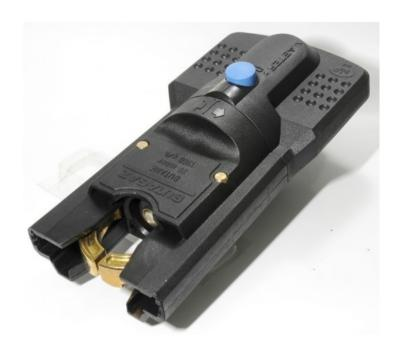
DETENDEUR BUTANE A SECURITE RAPIDE- Débit : 1,3Kg Détendeur à raccord rapide adaptable sur les bouteilles de 13 kg à robinet. Gaz butane, préssion 28mb
