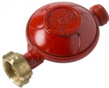
Gaz propane Raccordement vissant Débit 1,5kg Pression 37Mb Détendeur équipé d'un limiteur de débit, en effet en cas de débranchement, d'arrachement ou de sectionnement du tuyau, le détendeur se coupe seul. Il est ensuite bien sur réarmable manuellement.
