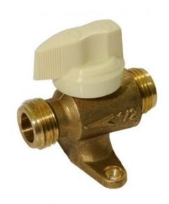
Vanne d'arrêt gaz, robinet R.O.A.I. gaz : Robinet gaz de sécurité à Obturation Automatique Intégrée (déclencheur par excès de débit) DN 12 DM 1/2 TS
