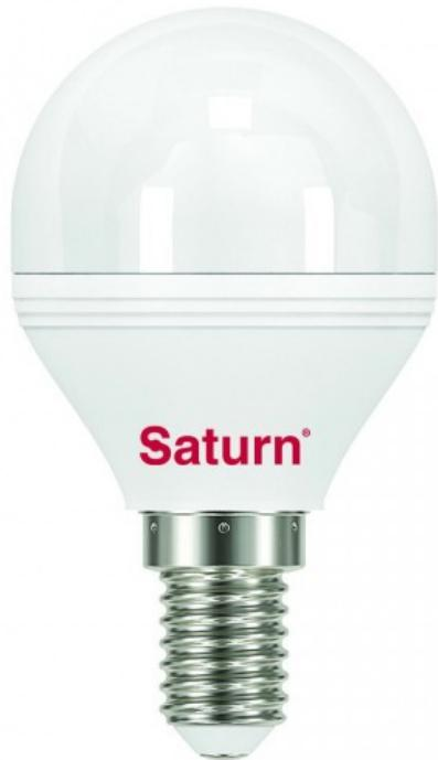
Ampoule LED à technologie SMD, sa puissance consommée n'est que de 7 watts pour un rendu lumineux de 620 lumens. Son culot à vis est au standard E27. De forme ronde d'une longueur totale de 80 mm (avec culot) et d'un diamètre de 45 mm. Sa température de couleur est de 3000K degrés Kelvin qui correspond à un blanc naturel et brillant. Elle dispose d'un grand angle de diffusion de 280°. Elle ne fonctionne pas avec un variateur de lumière. Classe énergétique A.
