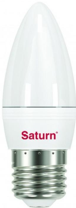
Ampoule LED à technologie SMD, sa puissance consommée n'est que de 7 watts pour un rendu lumineux de 600 lumens. Son culot à vis est au standard E27. De forme flamme d'une longueur totale de 108 mm (avec culot) et d'un diamètre de 38 mm. Sa température de couleur est de 4000K degrés Kelvin qui correspond à un blanc naturel et brillant. Elle dispose d'un grand angle de diffusion de 280°. Elle ne fonctionne pas avec un variateur de lumière. Classe énergétique A.
