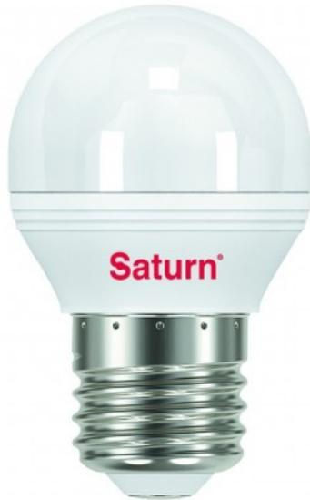
Ampoule LED à technologie SMD, sa puissance consommée n'est que de 7 watts pour un rendu lumineux de 620 lumens. Son culot à vis est au standard E27. De forme ronde d'une longueur totale de 80 mm (avec culot) et d'un diamètre de 45 mm. Sa température de couleur est de 4000K degrés Kelvin qui correspond à un blanc naturel et brillant. Elle dispose d'un grand angle de diffusion de 280°. Elle ne fonctionne pas avec un variateur de lumière. Classe énergétique A.
