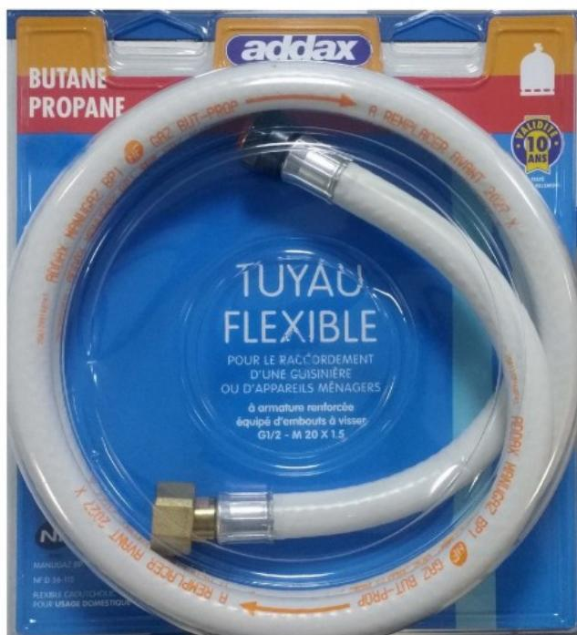
Gaz butane propane Longueur 2 mètres Validité 10 ans Tuyau flexible en caoutchouc renforcé par une armature pour un usage domestique, raccordement de cuisinière ou d'appareils ménagers. Embouts vissants G1/2 vers l'appareil et M20\*150 vers détendeur. Conforme à la norme XP D 36-112 Fabrication Française.
