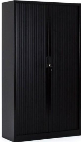
LXPXH:1200\*450\*1980CM Construction monobloc en tôle d'acier 8/10e et 10/10e. Portes à rideaux en PVC rigides non feu (classe MI). Fermeture 1 point par serrure à clés, poignée intégrée. 4 étagères pour dossiers suspendus avec ergots d'accrochage intégré. Étagères réglables au pas de 50 mm.
