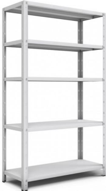
HAUTEUR: 2070 LONGUEUR: 1000 PROFONDEUR: 300 Supporte jusqu'à 150 kg par niveau Niveaux réglables chaque 138 mm Peinture en poudre d'époxy ou galvanisé Jusqu'à 1050 kg par module Montage sans vis
