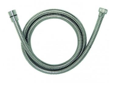
Flexible double agrafage en acier inox chroméFabriqué sous les normes EN1113 européenne. Tube intèrieur en PVC alimentaire et certifié. Couverture faite en bande d'inox de 17/100 d'épaisseur. Résistance à traction: 30 Kg. Écrou 0 moleté 1/2″ I Écrou 1 conique 1/2″ DIMENSIONS: 1,50 mètres
