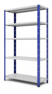
Supporte jusqu'à 150 kg par niveau Niveaux réglables chaque 138 mm Peinture en poudre d'époxy ou galvanisé Jusqu'à 1050 kg par module Montage sans vis
