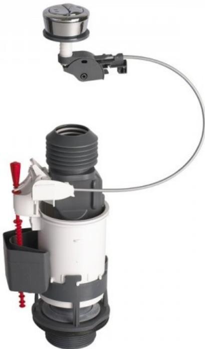
Grand classique de la gamme Wirquin Pro, le MW2 est un mécanisme double chasse compact à économie d'eau 3/6 L certifié NF et garanti 10 ans. Grâce à son système à câble, l'ajustement à la hauteur du réservoir se fait automatiquement. Mécanisme NF à double poussoir économie d'eau. Hauteur du réservoir : 300 à 420 mm. Diamètre de trou de couvercle : 14 à 46 mm. Ajustement automatique à la hauteur du réservoir.
