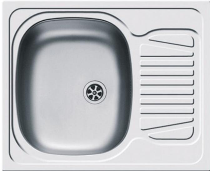
Evier Inox 18/10 réversibleBonde 60 à panier inoxSiphon Gain de place (prise lave-vaisselle sur siphon)Finition lisseVidage AutomatiquePré-percé Oui Ø 35mmFixation : Se fixe sur un plan de travailGarantie : Inox 15 ans (corrosion et tenue des soudures)DIMENSIONSDimension évier (mm )620 x 500Dimension des cuves (mm)340 x 400 x 150Dimension de découpe 600 x 480Dimension minimum du meuble 450 mmDiamètre de perçage robinet: 35 mm
