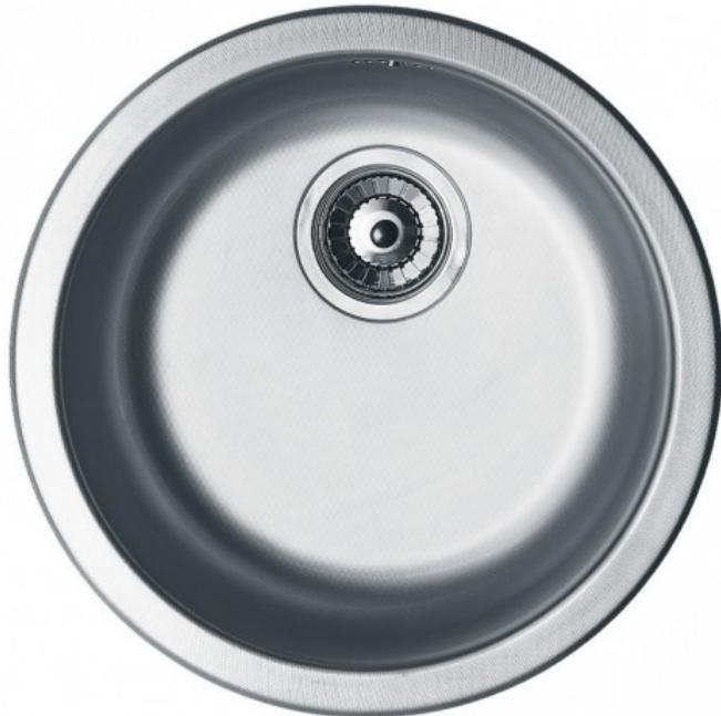
Evier Inox 18/10 réversibleBonde 90 à panier inoxFinition LisseSe fixe sur un plan de travailGarantie Inox 15 ans (corrosion et tenue des soudures)DIMENSIONSDimension évier (mm) Ø 450Dimension des cuves (mm) 385 x 163Dimension de découpe Ø 430Dimension minimum du meuble 450 mmDiamètre de perçage robinet 35 mm
