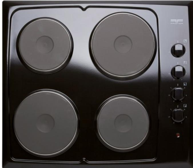
Table de cuisson encastrable finition acier émaillé noirPuissance totale 5000 watts composée de quatres foyers fonte, à l'avant droit 1000 watts diamètre 145mm et à l'arrière droit 1500 watts 180mm.A l'avant gauche 1500 watts 180mm et à l'arrière gauche 1000 watts diamètre 145mm.Commande par manettes.Livrée avec cordon (sans prise),pattes de fixation et joint.Dimensions du produitL 580 x H 40 x P 510mmEncastrement L 560 x P 490mm Poids 9.40 Kgs
