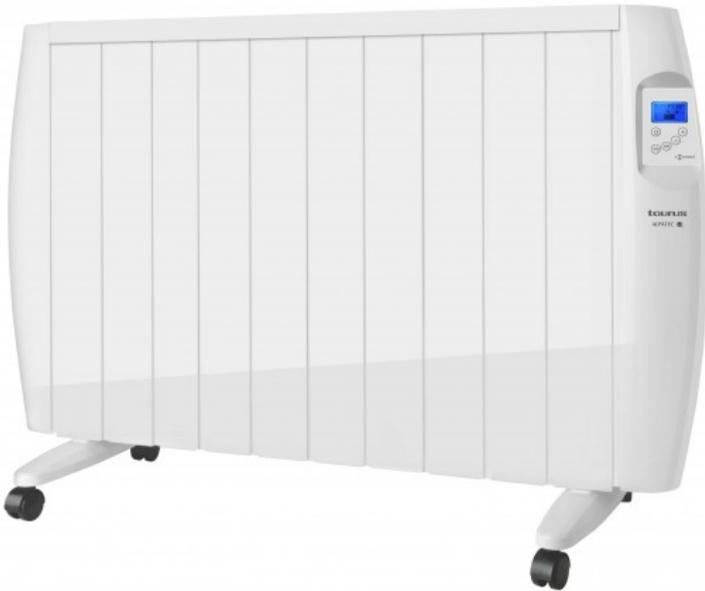
Malbork connect 2000 - radiateur à inertie sèche : la résistance électrique est moulée dans une plaque en aluminium qui va accumuler la chaleur et la faire rayonner pendant plusieurs heures après son arrêt dans toute la pièce à travers la façade thermo-conductrice.
