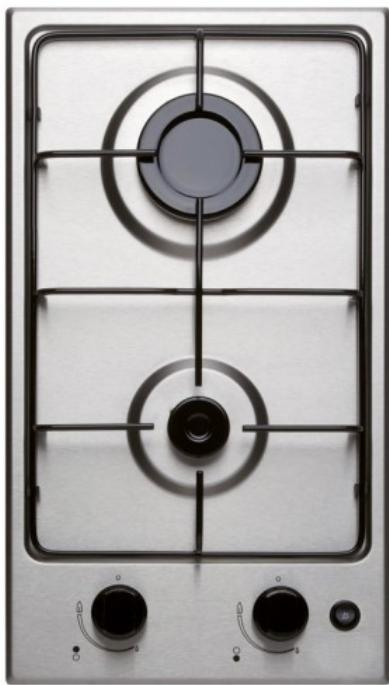
La table de cuisson gaz 2 foyers avec sécurité par thermocouple, pour un usage en toute sécurité. Ses deux brûleurs de 1kw de 55mm de diamètre et de 3kw de 100mm de diamètre pour une puissance totale de 4kw. Platine en acier inox équipé d'une grille émaillée. Deux manettes de commandes noires avec allumage par Piezzo. Ses dimensions hors tout sont de L290\*P510\*H42,5 et ses dimensions d'encastrement de L270\*P490 ce qui correspond généralement à la côte standard. Poids net 4,7Kgs.
