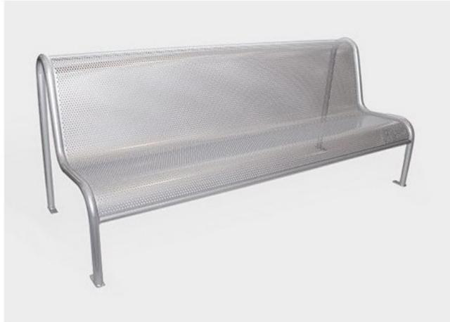
Banc avec piétement en acier de Ø 40mm avec siège et dossier en tôle d'acier perforée de 2mm d'épaisseur et trous de Ø 7mm avec traitement Ferrus, procédé qui protège le fer et garantit une résistance optimale à la corrosion.
