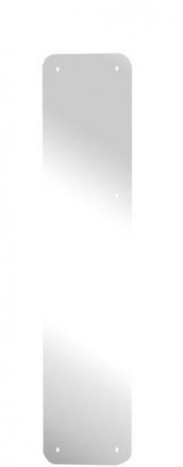
Reflet argent PMMA extrudé Miroir 5 mm Bords lisses et polis avec perçages des les angles et sur les longueurs à 10 mm des bords diamètre 4 mm puis sur la hauteur a 430mm des trous d'angle. Bords arrondis congés rayon 15 mm
