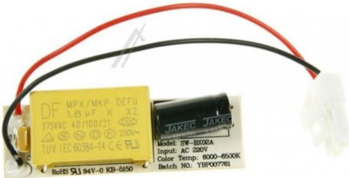
Platine électronique LED éclairage réfrigérateur CANDY
