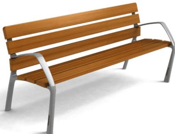
Banc avec **piètement en fonte ductile avec traitement Ferrus**, procédé qui protège le fer et garantit une résistance optimale à la corrosion. Le traitement Ferrus consiste en trois couches appliquées à la suite du nettoyage de toutes les impuretés par grenaiillage : un bain électrolytique, une couche époxy et une couche de peinture poudre polyester coloris gris martelé.
