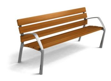
Banc avec **piètement en fonte ductile avec traitement Ferrus**, procédé qui protège le fer et garantit une résistance optimale à la corrosion. Le traitement Ferrus consiste en trois couches appliquées à la suite du nettoyage de toutes les impuretés par grenaillage : un bain électrolytique, une couche époxy et une couche de peinture poudre polyester coloris gris martelé.
