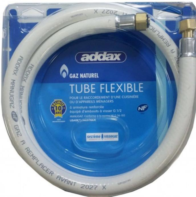
Gaz naturel Système Vissogaz recommandé par Gaz de France Testé individuellement Longueur 2 mètres Validité 10 ans Tuyau flexible en caoutchouc renforcé par une armature pour un usage domestique, raccordement de cuisinière ou d'appareils ménagers. Embouts vissants G1/2. Conforme à la norme NF D 36-103 Fabrication Française
