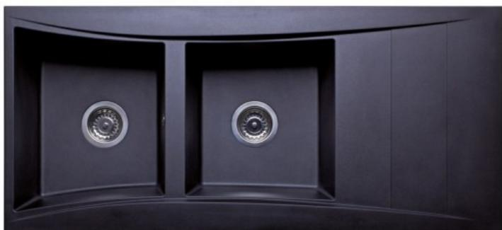
**CARACTERISTIQUES** Evier Résine SMC fibre longue Bonde 90 à panier inox Siphon Avec prise lave-vaisselle Finition Teinté dans la masse Réversible Oui Couleur Granité NOIR Fixation Se fixe sur un plan de travail Garantie 5 ANS **DIMENSIONS** Dimension évier (mm - L x P) 1160 x 530 Dimension des cuves (mm) 345 x 426 x 200 Dimension de découpe 1136 x 506 Dimension minimum du meuble 800 mm Diamètre de perçage robinet 35 mm
