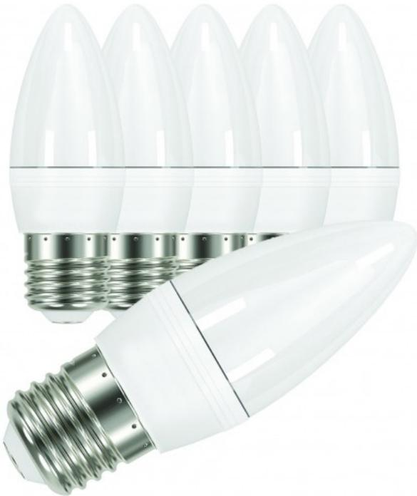
Ampoule LED à technologie SMD, sa puissance consommée n'est que de 7 watts pour un rendu lumineux de 600 lumens. Son culot à vis est au standard E27. De forme flamme d'une longueur totale de 108 mm (avec culot) et d'un diamètre de 38 mm. Sa température de couleur est de 4000K degrés Kelvin qui correspond à un blanc naturel et brillant. Elle dispose d'un grand angle de diffusion de 280°. Elle ne fonctionne pas avec un variateur de lumière. Classe énergétique A.
