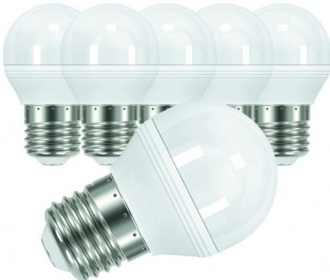
Ampoule LED à technologie SMD, sa puissance consommée n'est que de 7 watts pour un rendu lumineux de 620 lumens. Son culot à vis est au standard E27. De forme ronde d'une longueur totale de 80 mm (avec culot) et d'un diamètre de 45 mm. Sa température de couleur est de 4000K degrés Kelvin qui correspond à un blanc naturel et brillant. Elle dispose d'un grand angle de diffusion de 280°. Elle ne fonctionne pas avec un variateur de lumière. Classe énergétique A.
