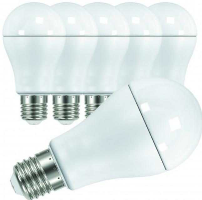
Ampoule LED à technologie SMD, sa puissance consommée n'est que de 10 watts pour un rendu lumineux de 1000 lumens. Son culot à vis est au standard E27. De forme ronde d'une longueur totale de 120 mm (avec culot) et d'un diamètre de 60 mm. Sa température de couleur est de 4000K degrés Kelvin qui correspond à un blanc naturel et brillant. Elle dispose d'un grand angle de diffusion de 280°. Elle ne fonctionne pas avec un variateur de lumière. Classe énergétique A.
