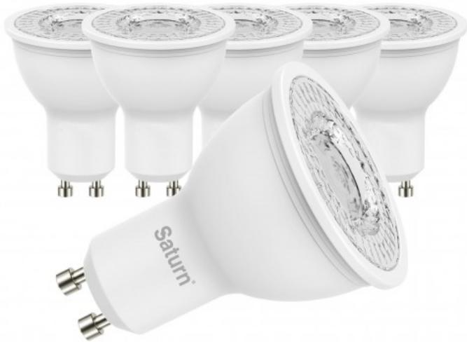
Spot LED à technologie SMD, sa puissance consommée n'est que de 7 watts pour un rendu lumineux de 550 lumens. Son culot à baïonnette est au standard GU10. De conique d'une longueur totale de 50 mm (avec culot) et d'un diamètre de 57 mm. Sa température de couleur est de 4000K degrés Kelvin qui correspond à un blanc naturel et brillant. Elle dispose d'un grand angle de diffusion de 110°. Elle ne fonctionne pas avec un variateur de lumière. Classe énergétique A.
